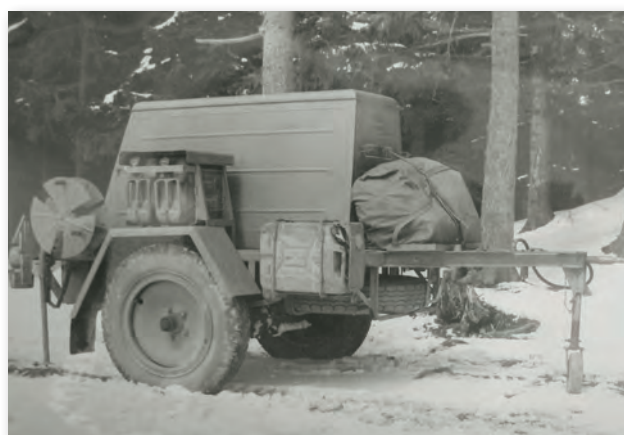
Elektrocentrála EC 7,5 kVa v soupravě LPS-65
