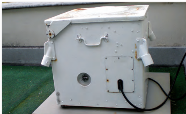
Měřič výšky spodní základny oblačnosti IVO – vysílací jednotka
