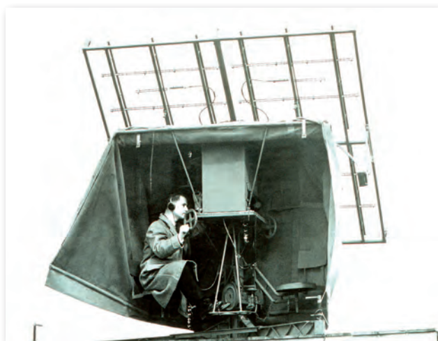
Radioteodolit SCR-658 využívaný v době 2. světové války armádou USA
