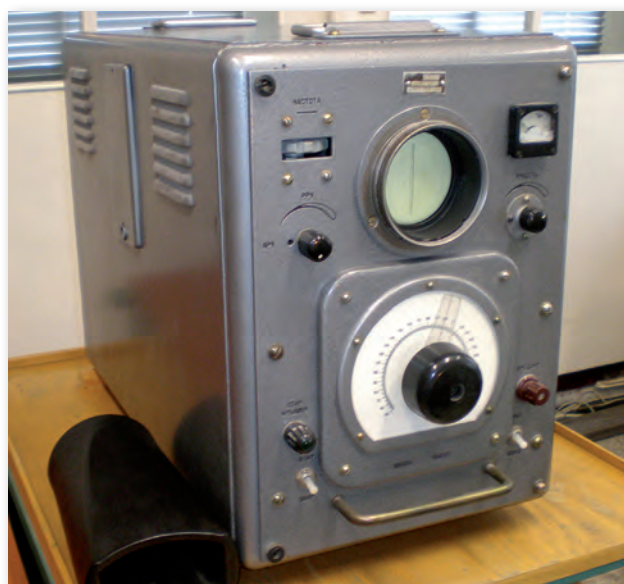
Měřič výšky spodní základny oblačnosti IVO – ovládací blok
