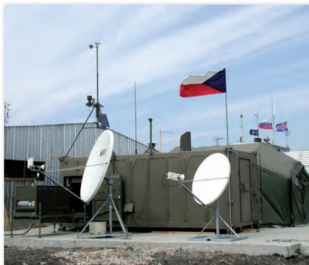
Rozvinutá mobilní hydrometeorologická stanice OBLAK na letišti v Prištině
