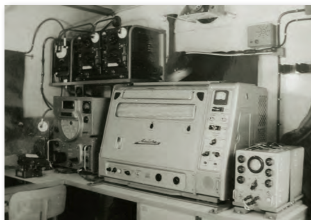
Zástavba pojízdné letecké meteorologické stanice LPS-65, fototelegrafická stanice FTA-K 2P LADOGA a osciloskopický přístavek OP-59
